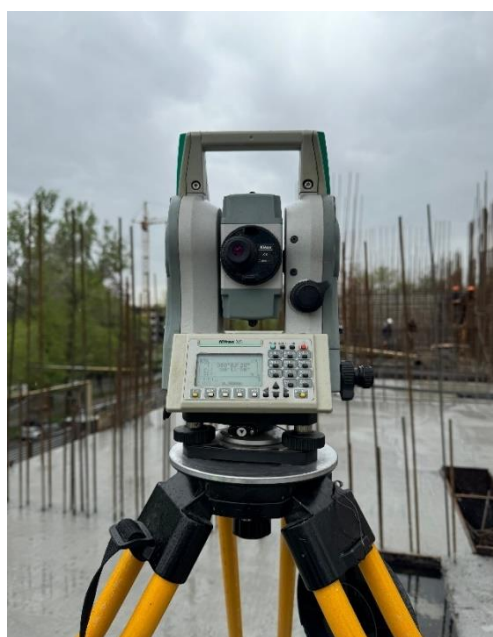
4.3-сурет – Электрондық тахеометр - Nikon XS
