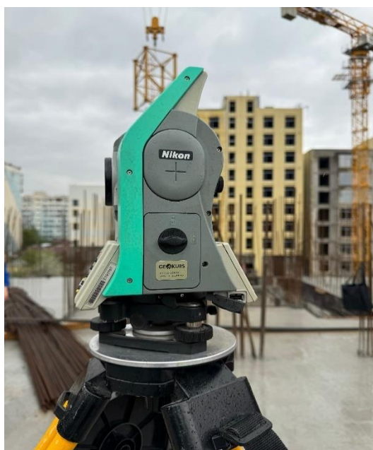
4.3-сурет – Электрондық тахеометр - Nikon XS
