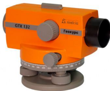
4.1-сурет – Оптикалық нивелир Геокурс GTX 132
