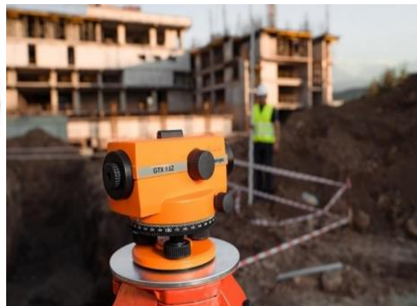
4.1-сурет – Оптикалық нивелир Геокурс GTX 132
